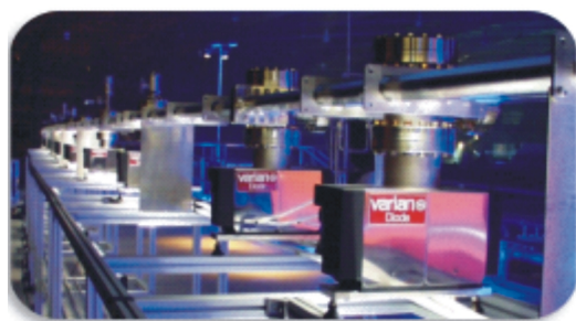
图 2 传统加速器真空系统实例
