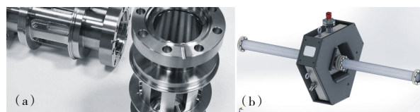
图 9 (a) 新型离子泵的内管道；(b) 新型离子泵与束线管道安装在一起
